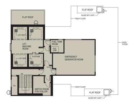
PLAN OF LIFT MACHINE ROOM (AT LEVEL 116.740) 升降機機房平面圖 (於水平116.740)
